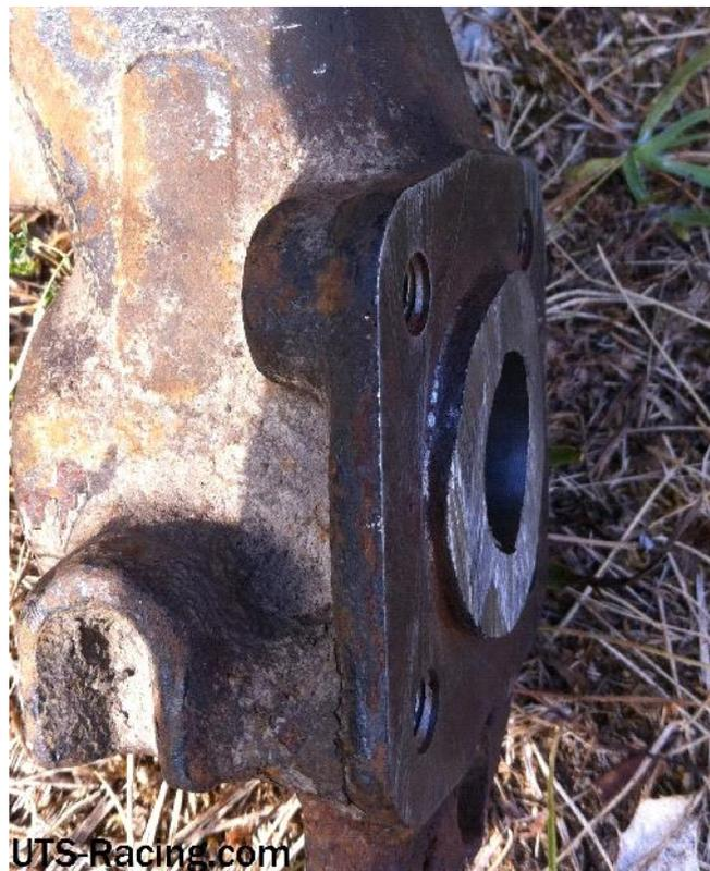
Une fois la coupe faite, on commence à surfaçer ce qu'il reste de l'épaulement afin de commencer à avoir une surface plane. On a utilisé une meuleuse avec un disque plus gros et de forme légèrement arrondi.
