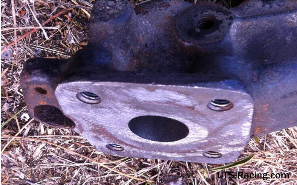
Une fois le surfaçage presque terminé, on fini à la lime pour être sûr de la planéité de la surface
